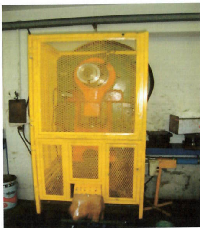
Figura 4 – Enclausuramento da área de Prensagem
